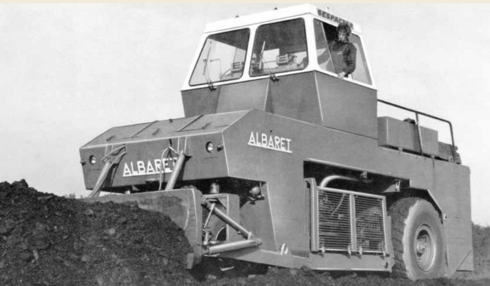
Mit Radlasten von bis zu 10 t und maximal ballastiert bis zu 50 t Gesamtgewicht war der „Geopactor“ ein echter Walzenkoloss, hier mit 3,6 m breitem Planierschild zum Einbauen der Kipperladungen.
